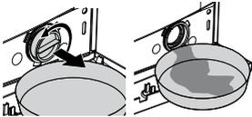
Stellen Sie ein großes Gefäß unter die Öffnung des Filters, damit das ablaufende Wasser hineinfließen kann. Lösen Sie den Pumpenfilter (gegen den Uhrzeigersinn), bis Wasser austritt. Leiten Sie den Wasserfluss in das Gefäß, das Sie unter dem Filter aufgestellt haben. Halten Sie am besten einen Lappen für den Fall bereit, dass etwas Wasser auf den Boden gelangen sollte. Wenn das Wasser vollständig aus der Maschine abgelaufen ist, drehen Sie den Filter komplett heraus.
