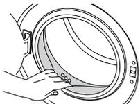
Falls die in der Abbildung gezeigten Öffnungen in der Gummidichtung verstopft sein sollten, entfernen Sie die Verstopfung mit einem Zahnstocher.
